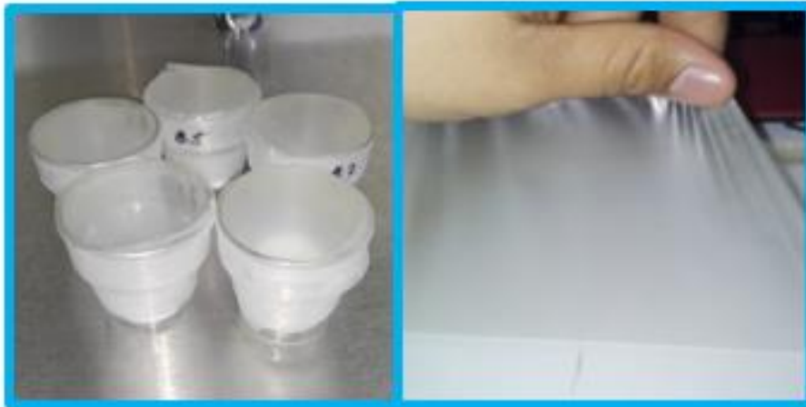
Figura 8. Películas comestibles de almidón de maíz acetilado y glicerol.
